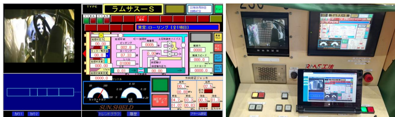
本製品による制御盤モニタリングの例（左：PCブラウザ画面表示例、右：タブレット端末表示例）
